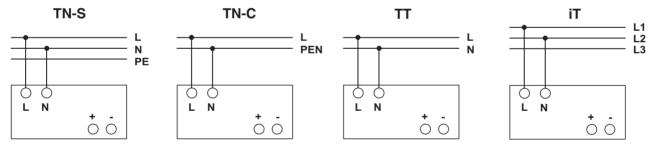
Der Anschluss für 100 V AC ... 240 V AC erfolgt über die Schraubverbindungen L und N. Das Gerät kann an 1-phasigen Wechselstromsystemen oder an zwei Außenleitern von Drehstromsystemen (TN-, TT- oder IT-Netz nach VDE 0100-300/IEC 60364-3) mit Nennspannungen 100 V AC ... 240 V AC angeschlossen werden.
