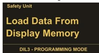
Um die Parameter für ein Sicherheitsgerät aus dem Flash-Speicher des BG200 zu laden, ist „Load Data From Display Memory“ angewählt und mit OK zu bestätigen.
