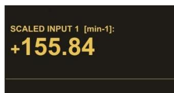
Bei dieser Anzeige wird die Eingangsfrequenz von Sensor1 mit den im Sicherheitsgerät eingestellten Parametern aus dem „OPU-Menu“ umgerechnet und angezeigt. \*) Siehe Kapitel 6.1
