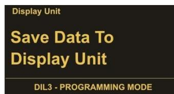
Um den Parametersatz im Bediengerät BG200 zu speichern, ist „Save Data To Display Unit“ anzuwählen und mit OK zu bestätigen.
