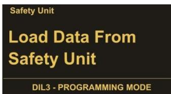
Um die aktuellen Parameter aus dem Sicherheitsgerät zu laden, ist „Load Data From Safety Unit“ anzuwählen und mit OK zu bestätigen.
