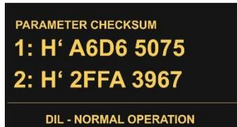
Bei dieser Anzeige wird die CRC-Checksumme über die im Sicherheitsgerät gespeicherten Parameterwerte angezeigt.
