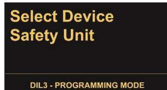
In der 1. Menüebene ist auszuwählen ob die Parameter des Sicherheitsgerätes oder die des Bediengerätes BG200 bearbeitet werden sollen. Für das Sicherheitsgerät ist „Safety Unit“ auszuwählen und mit OK zu bestätigen.
