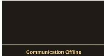
Bei der Statusmeldung „Communication Offline“ müssen die seriellen Einstellungen überprüft und ggfs. angepasst werden oder das Sicherheitsgerät aus- und wieder eingeschaltet werden, so dass sich sowohl das Sicherheits- als auch das Bediengerät neu initialisieren können.
