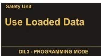
Um die bereits geladenen Parameter zu bearbeiten, ist „Use Loaded Data“ anzuwählen und mit OK zu bestätigen.
