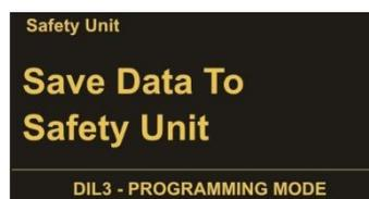
Um den Parametersatz im Sicherheitsgerät zu speichern, ist „Save Data To Safety Unit“ anzuwählen und mit OK zu bestätigen.
