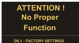
In diesem Modus werden beim nächsten Einschalten alle Parameter im Sicherheitsgerät auf Default-Werte gesetzt. Am BG200 ist keine Eingabe möglich!
