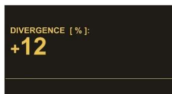
Bei dieser Anzeige wird die prozentuale Abweichung der beiden Eingangsfrequenzen zueinander angezeigt. (siehe „Div. Calculation“ des Sicherheitsgerätes).
