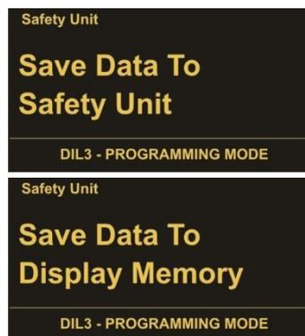
Um den Parametersatz des Sicherheitsgerätes im Sicherheitsgerät zu speichern, ist „Save Data To Safety Unit“ anzuwählen und mit OK zu bestätigen.
