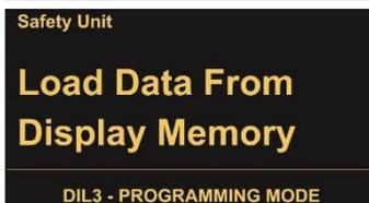
Um die Parameter für ein Sicherheitsgerät aus dem Flash-Speicher des BG200 zu laden, ist „Load Data From Display Memory“ anzuwählen und mit OK zu bestätigen.
