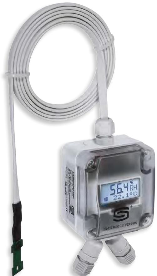
Contrôleur de point de rosée, y compris collier de serrage, avec tête de sonde déportée ( $\pm 3\%$ ), pour rapport de mélange, humidité relative/absolue, point de rosée, enthalpie et température, étalonnable, avec raccordement Modbus
