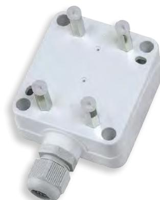
**FUNKTION** Der Lecksensor kann über DIP-Schalter so eingestellt werden, dass das Relais bei Normalbetrieb angezogen ist. Dies bedeutet, dass im Fehlerfall (Wasserschaden, Kabelbruch, Ausfall der Versorgungsspannung) das Relais abfällt. Somit kann auch ein Kabelbruch zum Sensor detektiert werden.
