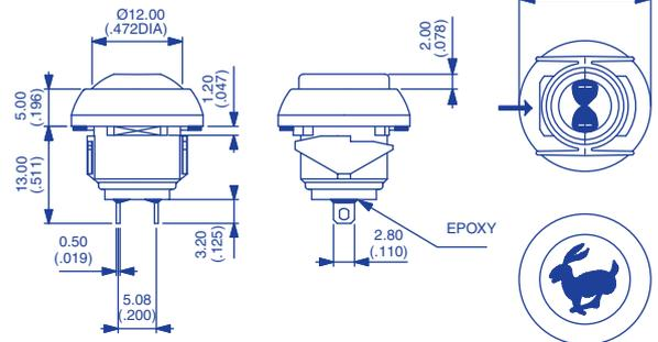
Existent aussi avec picots droits : **IB•3PAD** ou cosses à clips : **IB•3Z1AD**
