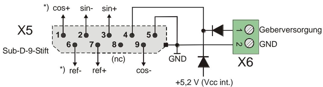
\*) Alle Differenzsignale (SIN+ / SIN-, COS+ / COS-, REF+ / REF-) sind im Gerät jeweils mit einem Widerstand von 120 Ohm abgeschlossen
