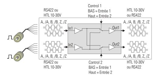
Les deux entrées peuvent être réglées individuellement soit au format A, /A, B, /B, Z, /Z, soit au format A, B, Z (niveau TTL / RS422 ou HTL 10-30V).
