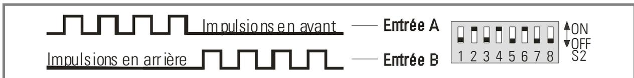
Dans le dernier cas il faut observer que toujours une des deux entrées reste à niveau LOW pendant que l'autre entrée reçoit les impulsions
