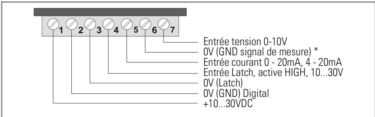
\*) Cette entrée est isolée électriquement afin d'éviter les signaux parasites véhiculés par la tension d'alimentation. Il faut donc relier, pour la mesure, le conducteur du signal le plus négatif à l'entrée de masse analogique de référence.
