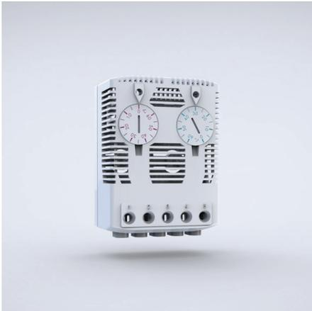
**Beschreibung:** Ein Gehäuse - zwei unabhängige Thermostate. Thermostat (Grundeinstellung geschlossen) zur Regulierung der Heizungen. Thermostat (Grundeinstellung geöffnet) zur Regulierung von Filterlüftern, Wärmetauschern und Anzeigemodulen. Sensorelement Thermostatisches Bimetall. Montage-Clip für 35mm DIN Schiene (EN 60715).
