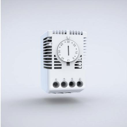
**Beschreibung:** Thermostat mit Wechselkontakt zur Regulierung von Temperatur im Schrank. Sensormaterial thermostatisches Bimetall. Montage-Clip 35mm DIN Schiene (EN 60715).
