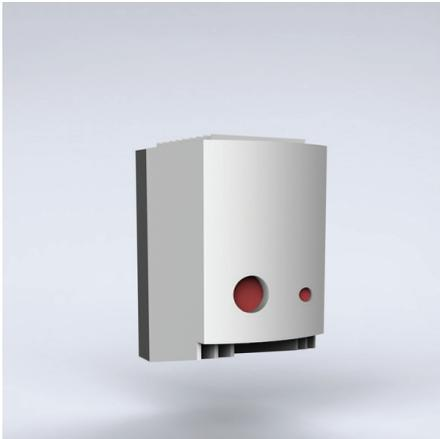
**Beschreibung:** Hochleistungsheizer zur Vermeidung von Kondensation. Der Lüfter unterstützt die natürliche Konvektion für eine bessere Wärmeverteilung. Doppelt isoliert. Zur vertikalen Installation. Montage-Clip für 35 mm DIN-Schiene (EN60715). Temperatur-Sicherheits-Abschaltung gegen Überhitzung bei Lüfterausfall. Thermostat-Kontroll-Lämpchen.
