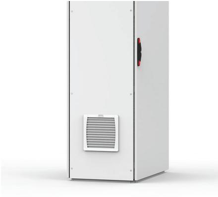
**Beschreibung:** Austrittsfilter zur natürlichen Ventilation oder zur erzwungenen Ventilation in Kombination mit einem Filterlüfter der EF-Serie. nVent HOFFMAN-Austrittsfilter sparen Zeit, da sie mit einem einfachen Click-In System ohne Schrauben montiert werden. Die scharnierte Front kann für einen schnellen und einfachen Filterwechsel geöffnet werden. Filter-Effizienz 88% (91% bei EFA500R5 und größer).
