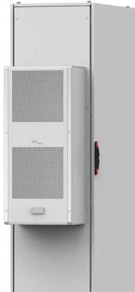
**Beschreibung:** Hochleistungskühlgerät zur vertikalen Montage. Das Gerät wird an der äußeren Oberfläche befestigt um maximalen Platz für den Innenraum zu gewährleisten. Die Kühlleistung liegt zwischen 360 W und 5950 W. Alle Geräte besitzen einen selbstreinigenden Kondensator die den Einsatz eines Luftfilters überflüssig machen. Modelle ab 1000 W sind mit einem Kondensatablauf. Ein elektronische Thermostat (ECB) ist ab 500W vorhanden. Ozon-freundliches Kältemittel R134a.
