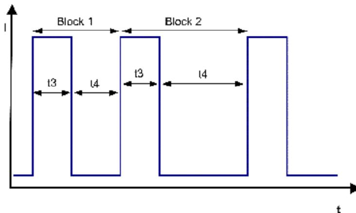
Block1: spezieller Blockierschutz 5 Zyklen  $t_3 / t_4 = 0,6 \text{ s} / 0,5 \text{ s}$  Block2: Blockierschutz  $t_3 / t_4 = 0,6 \text{ s} / 10 \text{ s}$
