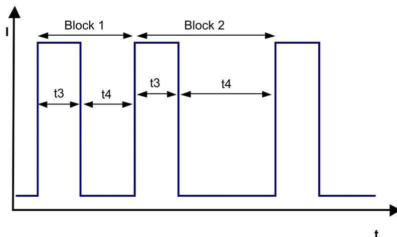
Block1: spezieller Blockierschutz 5 Zyklen t<sub>3</sub> / t<sub>4</sub> = 0,6 s / 1 s Block2: Blockierschutz t<sub>3</sub> / t<sub>4</sub> = 0,6 s / 10 s
