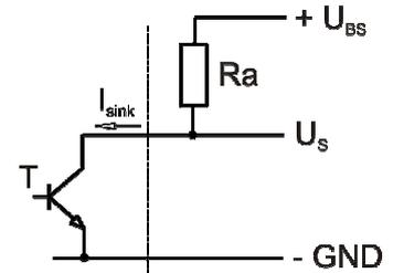
Lüfter-Drehzahl / *Fan speed*
