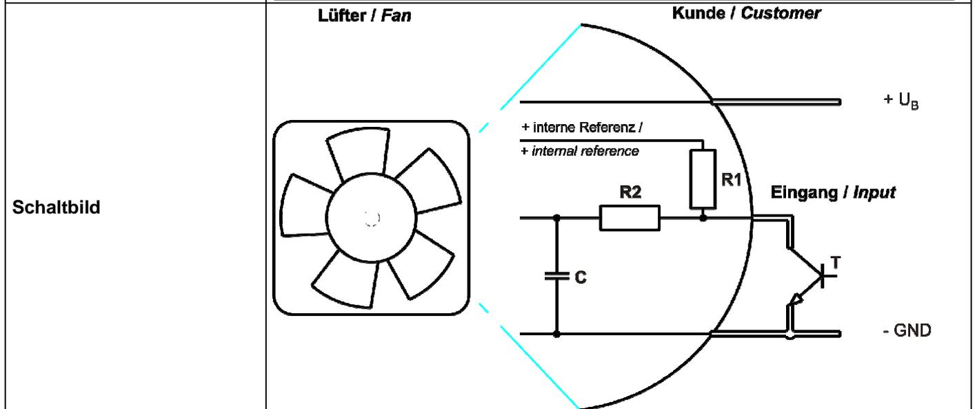
Drehzahlregelung: 0... 100 %, PWM-Low < 0,2 V
