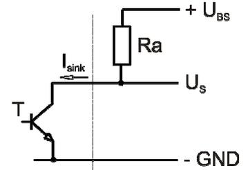
Lüfter-Drehzahl / Fan speed
