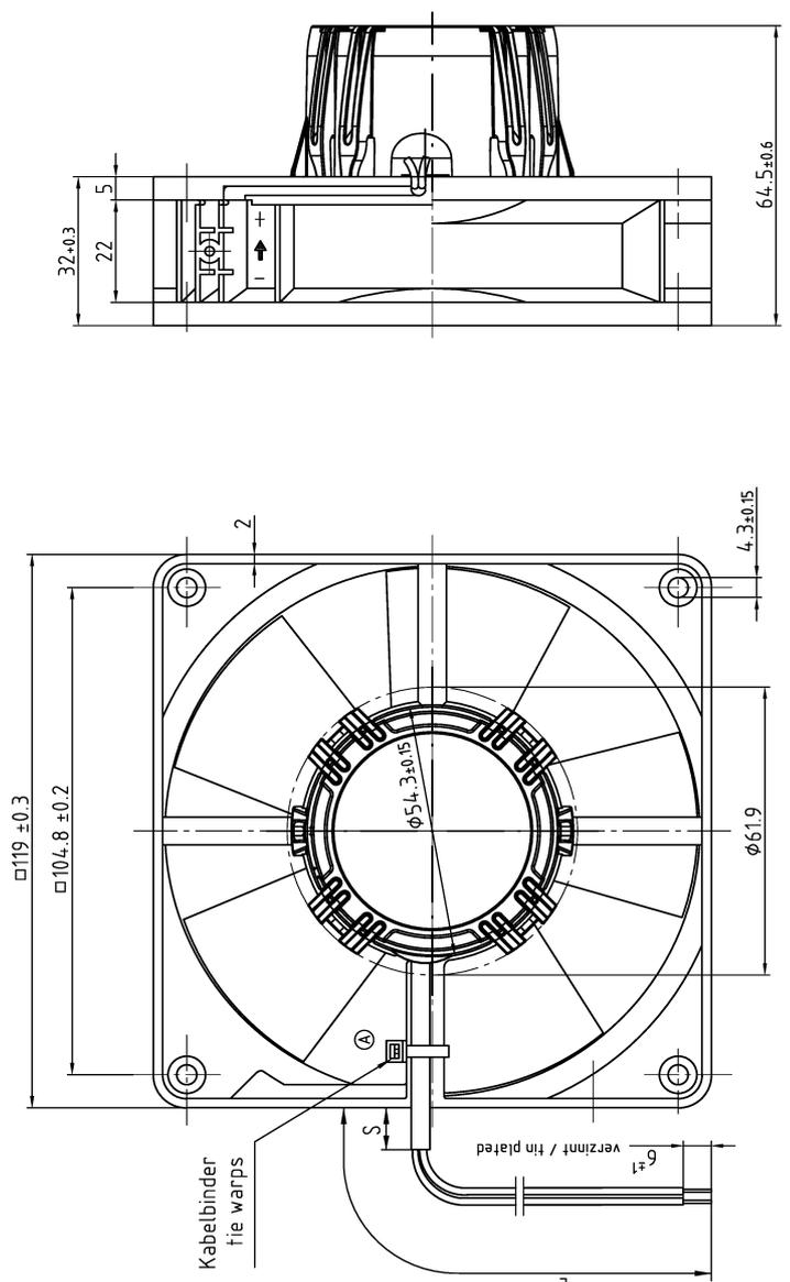
Anzahl und Länge der Litzen (L) sowie Schlauchlänge (S) siehe Produktspezifikation
