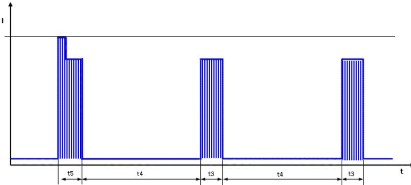
Erster Puls  $t_5$  typisch 1,6s (1,3 .. 1,9s) gefolgt von  $t_4$ . Danach zyklisch  $t_3/t_4$ .
