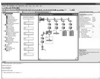
MT Works2 ist eine integrierende Start-up-Software zur Strukturierung und Konfigurierung von Anwendungen des Motion-Control-Systems der MELSEC System Q.
