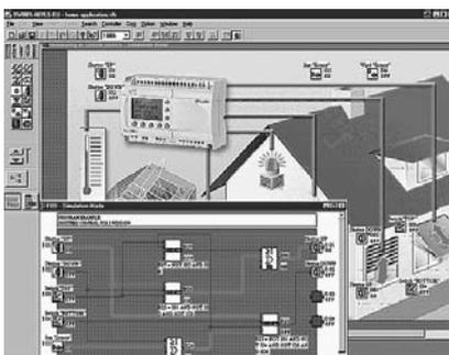
Alle Steuerungen der ALPHA-Familie können mit dieser Windows-Software programmiert werden. Sie ist sehr leicht zu handhaben, es sind keine speziellen Vorkenntnisse des Anwenders erforderlich. Bei der Programmierung werden auf einer grafischen Programmieroberfläche die verschiedenen Elemente eines Programms gesetzt: links die Eingänge, rechts die Ausgänge, in der Mitte die verschiedenen vorprogrammierten Funktionsblöcke.
