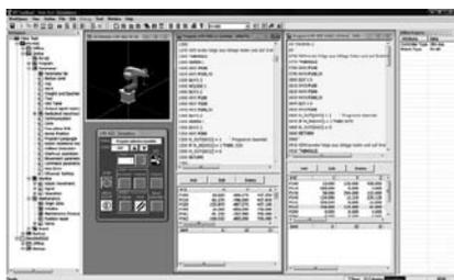
Die RT ToolBox2-Software unterstützt Sie bei der Programmierung aller MELFA-Roboter und bei der Verwaltung Ihrer Projekte. Durch die intuitive Bedienung ist die Projekterstellung klar gegliedert und deswegen auch für Einsteiger sehr leicht zu bedienen. Optional ist die Software auch mit einem Simulator erhältlich, der Ihr erstelltes Roboterprogramm simuliert und die zu erwartende Zykluszeit berechnet, bevor Sie sich für einen Robotertypen entschieden haben.
