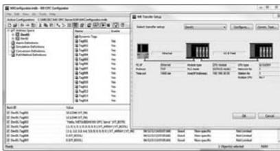
Der MX OPC-Server ist ein Mitsubishi Electric OPC Data Access (DA) E/A-Treiber und Alarm/Ereignis (AE)-Server, der die Schnittstelle und das Kommunikationsprotokoll zwischen Mitsubishi Electric Hardware und Ihrer Prozesssteuerungssoftware bildet. Mitsubishi Electric-Treiber binden OLE-Automationstechnologie und OPC-Bereitschaft ein, um Flexibilität und einfache Anwendung zu bieten.
