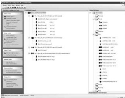
GX Configurator DP ist eine benutzerfreundliche Konfigurations-Software für das offene Netzwerk Profibus DP. Sie kann zur Konfiguration der Profibus DP-Master-Module und aller Slave-Module, einschließlich der Frequenzumrichter und HMIs von Mitsubishi Electric und Produkten anderer Hersteller, eingesetzt werden.
