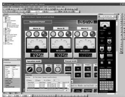
Ein Bestandteil von GT Works stellt das grafische Erstellungsprogramm GT Designer dar, mit dem Bedienbildschirme für alle GOT-Bediengeräte erstellt werden können. Mit Hilfe der bedienerfreundlichen Windows-Benutzeroberfläche wird der Anwender in die Lage versetzt, schnell und nachvollziehbar, ohne lange Einarbeitungszeiten und Arbeitskosten zu vergeuden, das Programm zu bedienen. Das Software-Paket besteht aus:
