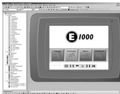
E Designer ist eine komplett PC-basierende Programmier-Software für die HMIs der E-Serie. Projekte können in Menühierarchie oder als Bedienabfolge aufgebaut werden, die den Anwender durch eine leicht verständliche logische Abfolge von Bedienschritten führt. Die Hauptmerkmale sind:
