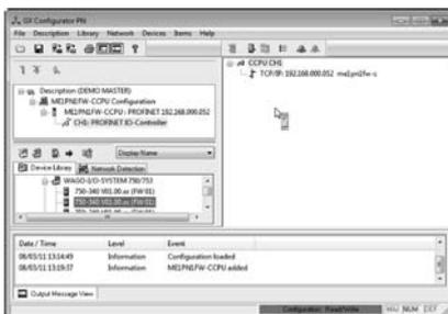
GX Configurator PN ist das Konfigurationswerkzeug für Profinet-E/A-Module. Die Software bietet Funktionen, die von der Konfiguration des Profinet-E/A-Netzwerks und dem Testen der Konfiguration bis zur Übertragung der Einstellungen in die Profinet-Module reichen.
