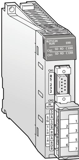
Die Schnittstellenmodule ermöglichen die serielle Kommunikation mit externen Geräten. Pro Kanal sind Übertragungsgeschwindigkeiten von bis zu 230,4 kBit/s möglich. Verschiedene Kommunikationsprotokolle, wie etwa Modbus®, sind vordefiniert.
