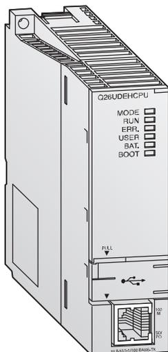
Die Universal CPUs sind die neueste Generation in der Familie der modularen Steuerung MELSEC System Q. Sie bilden das Kernstück der iQ Platform. Zusammen mit der Motion-, Roboter- und NC-CPU bieten sie ein modulares, skalierbares und flexibles Automatisierungssystem.
