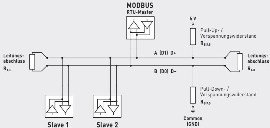
Über DIP-Schalter kann der Busabschluss komplett zu- oder abgeschaltet werden. Dabei werden sowohl die BIAS-Widerstände, die separat über DIP2 aktiviert werden können, als auch der Leitungsabschluss-Widerstand zwischen den beiden Datenleitungen A und B zu- oder abgeschaltet. Im Servicefall können dadurch auf einfache Weise verschiedene Betriebsszenarien geprüft werden.
