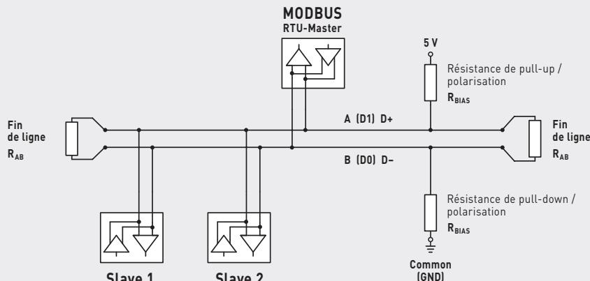
La terminaison de bus peut être activée ou désactivée complètement à l'aide de commutateurs DIP. Les résistances BIAS, qui peuvent être activées séparément via le **DIP 2**, et la résistance de terminaison de ligne entre les deux lignes de données A et B sont activées ou désactivées. En cas d'entretien, différents scénarios d'exploitation peuvent ainsi être testés facilement.
