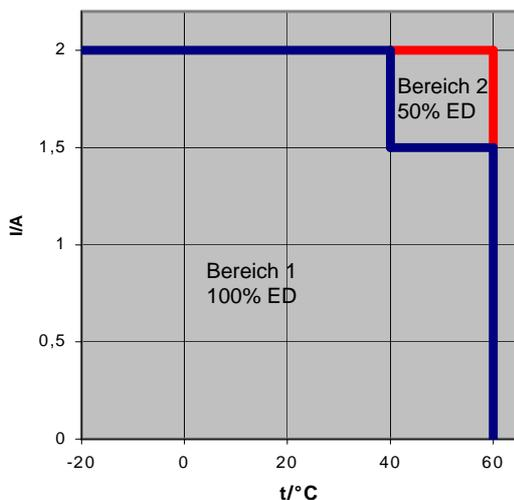
Für die Betrachtung der Einschaltdauer sind nur die Lade- und Entladezyklen der Kondensatoren relevant. Ist das Puffermodul aufgeladen und arbeitet im Standbymodus tritt keine Erwärmung des Gerätes auf. Dieser Fall ist somit thermisch mit einem ausgeschalteten Gerät gleichzusetzen.
